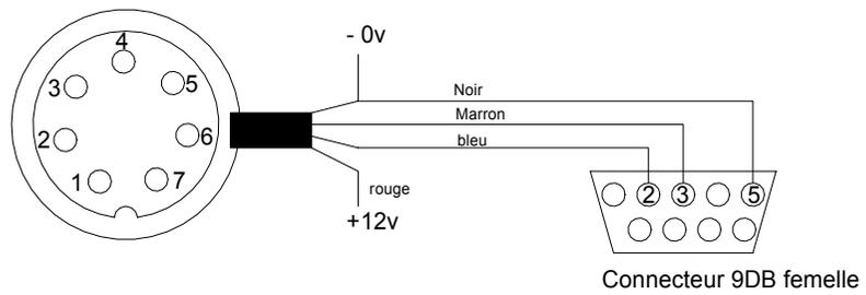
Mise en place d'un connecteur RS232 sur un GPS GARMIN 128
